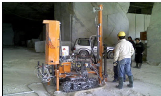
Versione con aspiratore di polveri (opzionale) Machine equipped with dust collector (optional)
